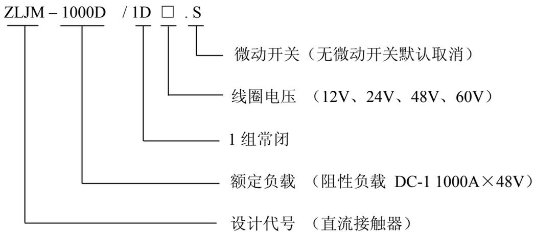
例：ZLJM-1000D/1D48；表示：常闭直流接触器，DC-1 负载下额定电流为 1000A，线圈电压 DC48V。
