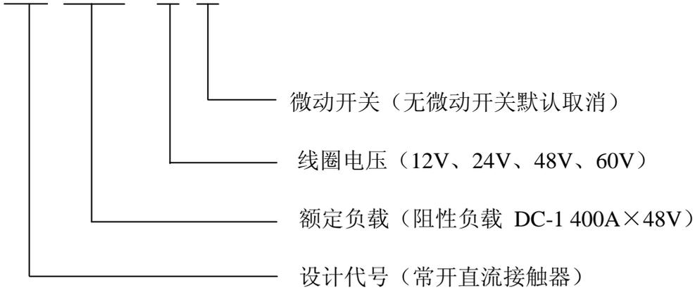
例：ZLJ-400A/48；表示：常开直流接触器，DC-1 负载下额定电流为 400A，线圈电压 DC48V 。
