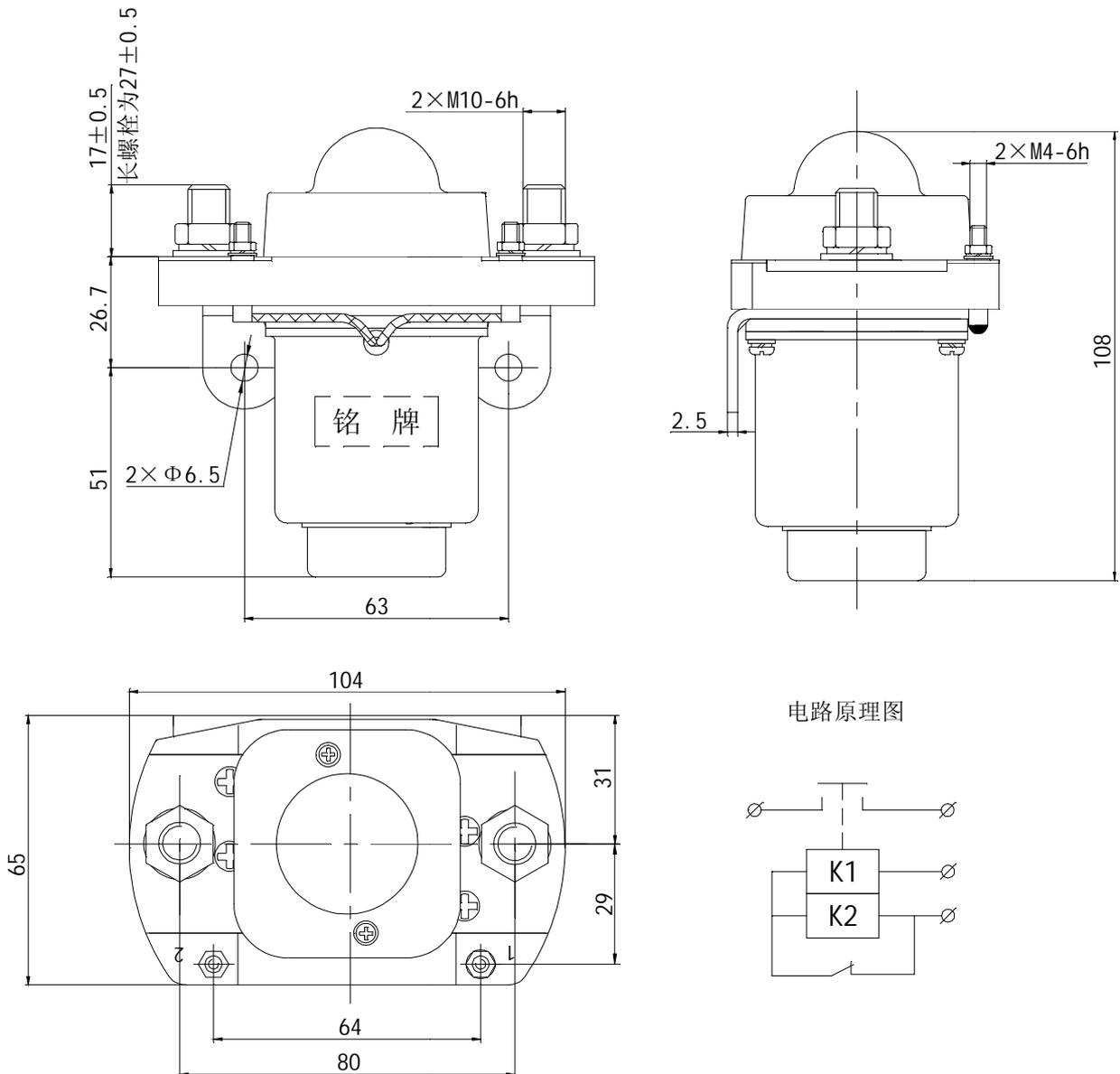
注：1. 常规产品的主回路接线螺钉为 M10\*20；如需更换为 M10\*30 的主回路接线时请在产品型号后加“(L)”如：ZLJ-400A/48(L)表示为长螺栓产品。
