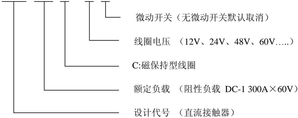
例：ZLJM-300C/48.S；表示：磁保持直流接触器，DC-1 负载下额定电流为 300A, 线圈电压 DC48V，带辅助回路微动开关。
